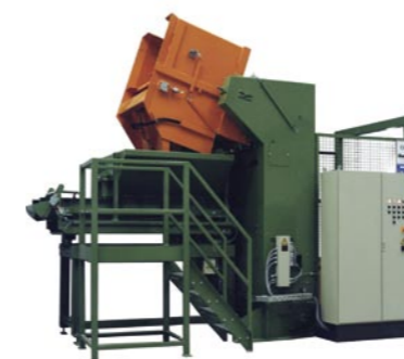
Dosierte Beschickung einer Schneckenwaschmaschine für Schrauben Type MD for metered feeding of screws into an industrial washing machine Alimentation dosée d'une installation de lavage de boulonnerie
