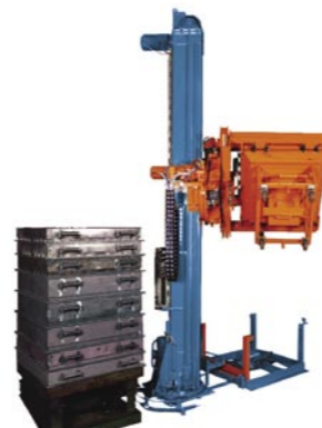
MSH zum Stapeln und Entstapeln von Siebkörben MSH to stack and remove stacks of screen baskets MSH pour empiler et désempler des tamis
