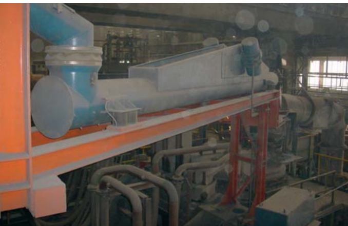
Förderrohr mit Unwuchtantrieben zur Beschickung eines Pfannenofens.
