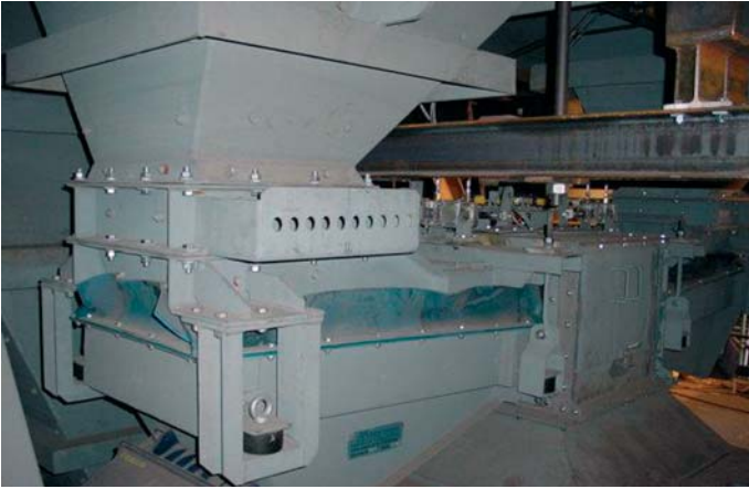
Elektromagnetische Bunkerabzugsrinne zur Wiegebunkerbeschickung.
