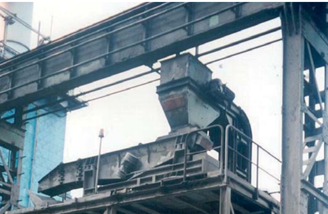
Gießpfannenbeschickung mittels schwenkbarer Schwingförderrinne.
