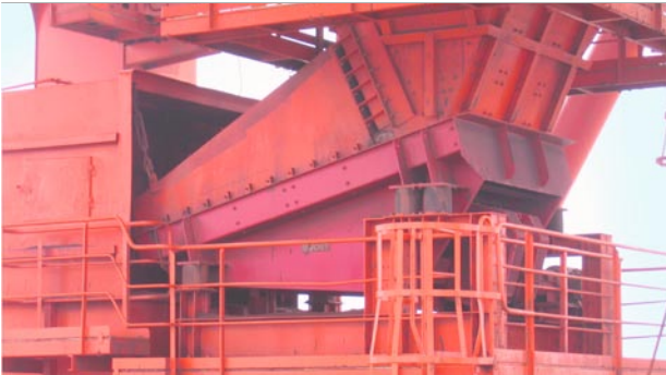
Bunkerabzug in schwerer Ausführung für Kohle und Eisenerz Bin discharge in heavy execution for coal and iron ore Extracteur série lourde sous trémie pour charbon et minerai de fer
