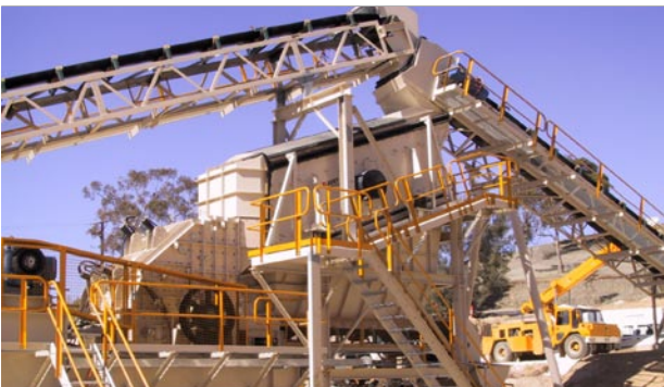
Doppeldeck-Kreisschwingsieb in staubdichter Ausführung Doubledeck-circular-motion screen in a dust tight execution Crible circulaire étanche à deux étages
