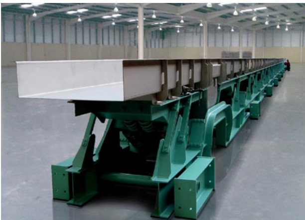
Massenkompensierte Förderrinne FSM – 60 m lang – für die Lebensmittelindustrie mit Produktverteilsystem (rechts).
