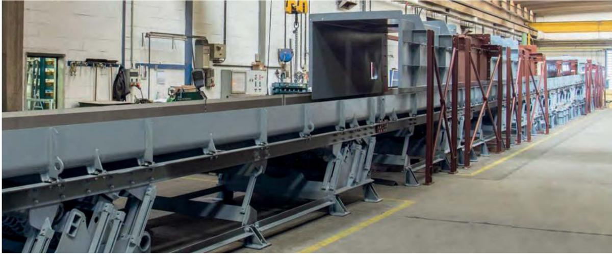
Die JÖST Schwingförderrinne Typ FSM für einen europäischen Kunden wird unter zwei Müllverbrennungsöfen zum Abtransport von verbrannter Müllschlacke zum Aschebunker eingesetzt. Die Schwingförderrinne FSM funktioniert auf Basis der massenkompenzierten Resonanz – die eingeleiteten Schwingungen und die dynamischen Kräfte werden durch die in der Anlage befindlichen aktiven Schwingungstilger aufgefangen. Hierdurch verringert sich die Kraftübertragung auf die Fundamente und den Stahlbau beträchtlich.
