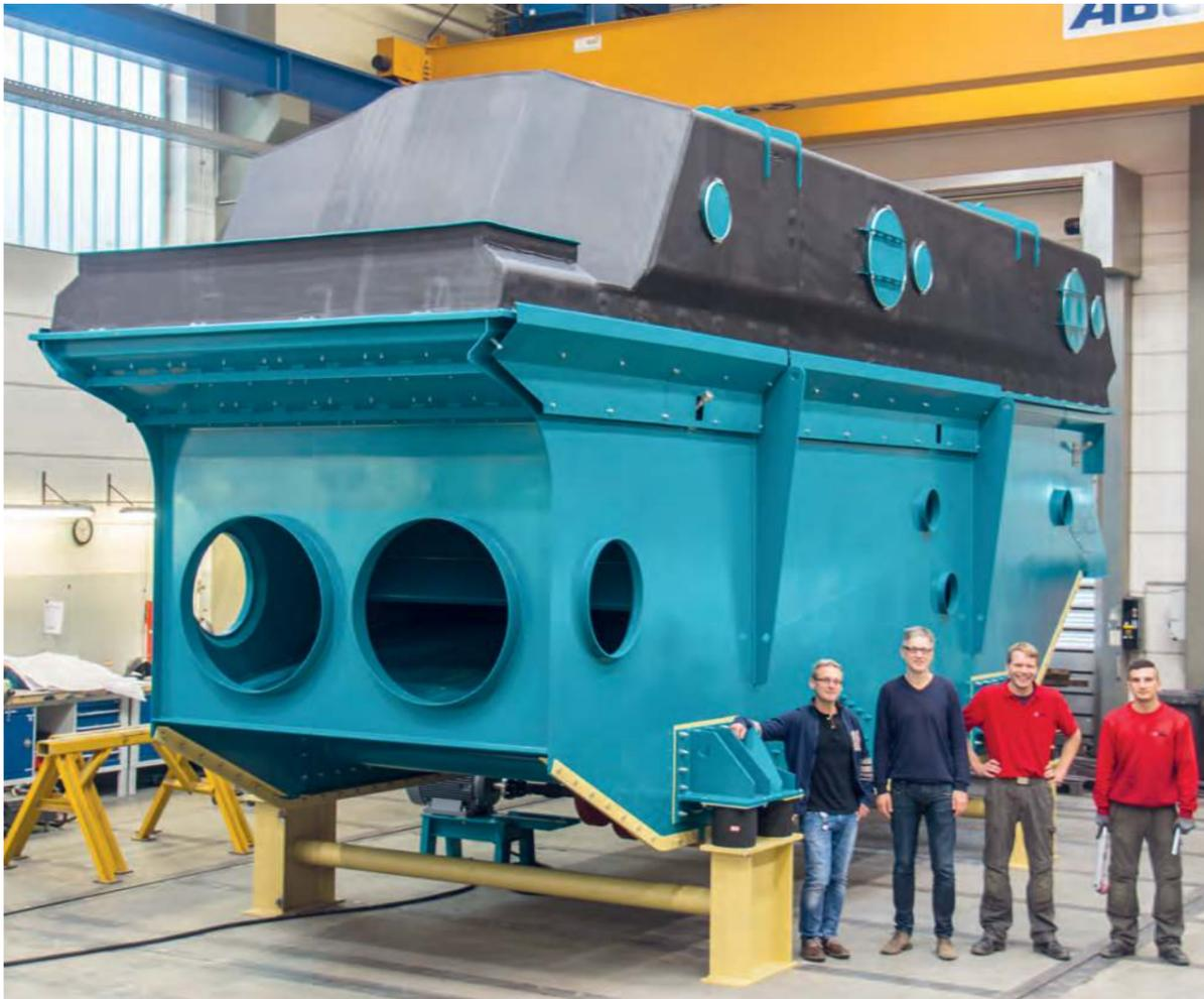
JÖST Vibrationsfließbettrockner für Schüttgüter übertragen die zur Trocknung erforderliche Wärmeenergie durch Konvektion, d.h. direkte Wärmeübertragung, so dass das Wärmeübertragungsmedium direkt mit dem Produkt in Kontakt kommt. Die Wärmeübertragung erfolgt typischerweise mittels temperatur geregelter Warm- bzw. Heißluft. Eine Unterteilung in unterschiedliche Zonen zur Trocknung und Kühlung ist möglich.
