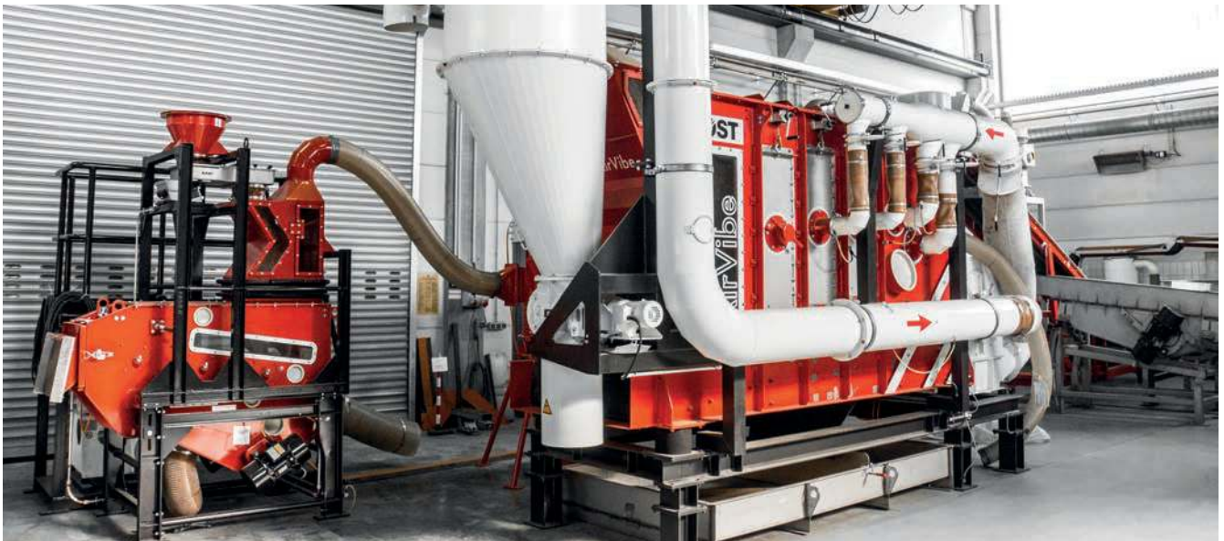
Trenntisch, K-Sichter und Vibrationssichter AirVibe / Separation Table, K-Sifter and Vibration Air Separator AirVibe
