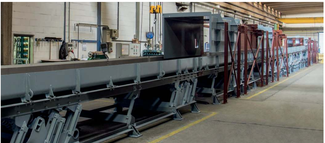
Schwingförderrinne zum Transport von Müllschlacke / Vibrating Trough Type Feeder for Transport of Waste Slag
