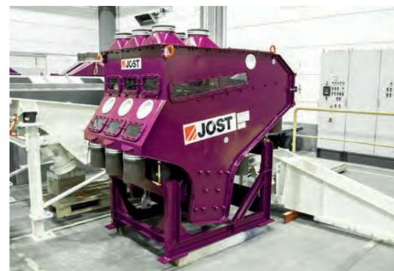
Für die patentierte Aufbereitungsanlage liefert JÖST die Sieb- und Separationstechnik. Diese besteht aus Langteilabscheidern, Spannwellensieb, Windsichtern und 3-fach Trenntischen. Ziel der Aufbereitung ist die Rückgewinnung von Feinmetallen und die Separierung zwischen leichten und schweren Metallen.
