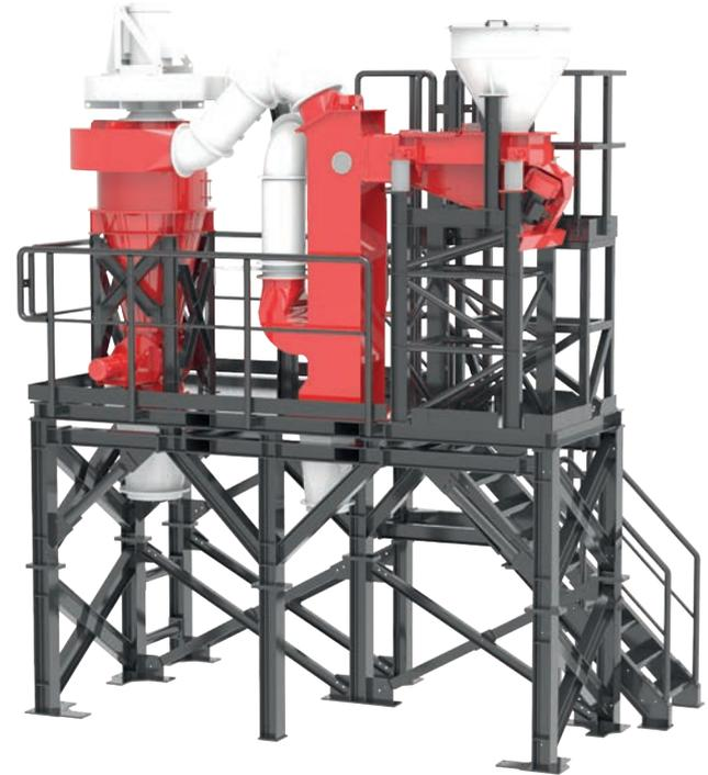
Der **Trenntisch** eignet sich für alle oberflächentrockene, rieselfähigen Schüttgüter mit einer Korngröße bis ca. 10mm. Das Sortiergut wird über eine mitschwingende Produktaufgabe über die gesamte Maschinenbreite verteilt aufgegeben. Durch die kombinierte Wirkung der Vibration des Tisches und die von unten luftdurchströmte Siebplatte wird die Reibung der Partikel untereinander weitgehend aufgehoben.
